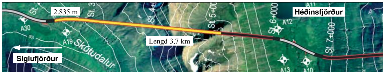
Staða framkvæmda við Héðinsfjarðargöng 19. nóv. 2007. Búið er að sprengja 2.835 m í Siglufirði og 1.899 m í Ólafsfirði.
